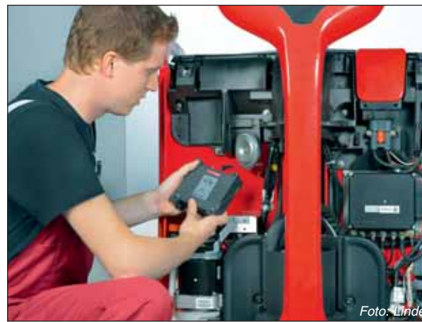
Hardwarové části nezbytné pro systém connect: mohou být objednaný přímo s novým vozíkem již z výroby a jsou k dispozici i jako náhradní díly pro dovybavení již stávajících vozíků.
